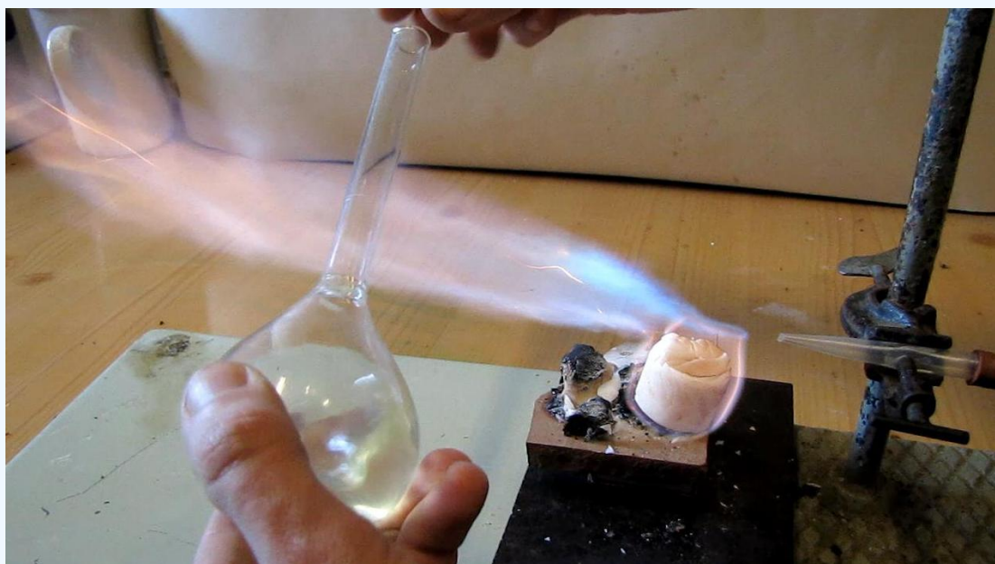
Запаивание колбы - неудачная попытка фото В.Н. Витер
